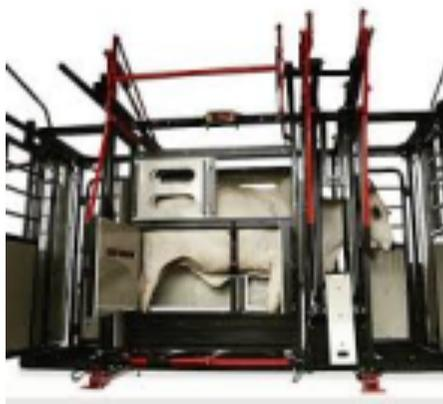
**Parede Móvel Total Flex:** a contenção é feita pelo movimento das paredes laterais do equipamento, que se ajustam ao corpo da rês.
