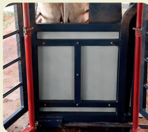
Estrutura robusta em aço com revestimento em polipropileno tem alta resistência a impacto.
