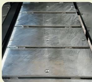
O monobloco com chassis está preparado para receber a instalação de balanças eletrônicas, facilitando o acompanhamento do rebanho. Destaque na foto para o piso zincado, proporcionando maior resistência e durabilidade.
